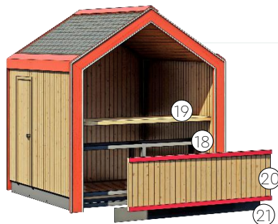
5. Установка каркаса прилавка и монтаж обшивки
