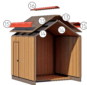
4. Крепление щитов, капельников и конька с обшивкой для кровли
