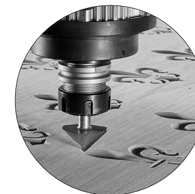
Глубина фрезеровки может достигать до 50 мм. Максимальная глубина резки за один проход 5 мм
