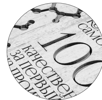
Рисунки и текст наносится на деревянные элементы с помощью фрезеровки
